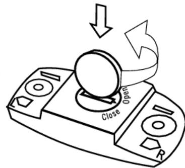
为了延长电池的使用寿命，只在需要更换电池时才将其打开。更换电池时，要确认密封圈没有出现损坏。如有损坏，需要更换一个新的密封圈。
